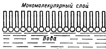
Рис. 215. Расположение молекул жирных кислот в мономолекулярном слое на поверхности воды.
