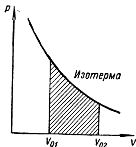
Рис. 173. Работа при изотермическом расширении газа изображается площадью заштрихованной фигуры.
